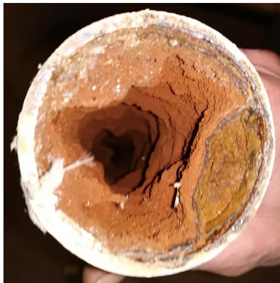
Tuberkulatsioon joogiveetoru seinal. Mustamäe tee 18, Tallinn
